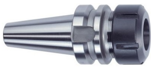
Spannzangenfutter ER gewuchtet G6,3 15.000 U/min
