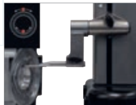
Durchmessermessung mit grafischer Hilfe
