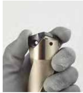
③ Leichtes Anpressen beim Festschrauben verhindert ein Verdrehen,
