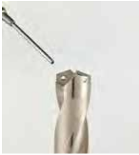
① Reinigen Sie den Plattensitz,
