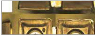
Wettbewerb A 230 Bohrungen (21 m) Abplatzen an der Schneidkante
