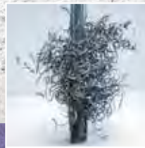
(1B) Gewindebohrer Traditional tap
